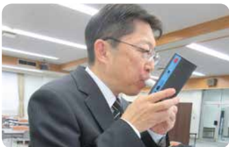
一酸化炭素濃度測定中の様子
